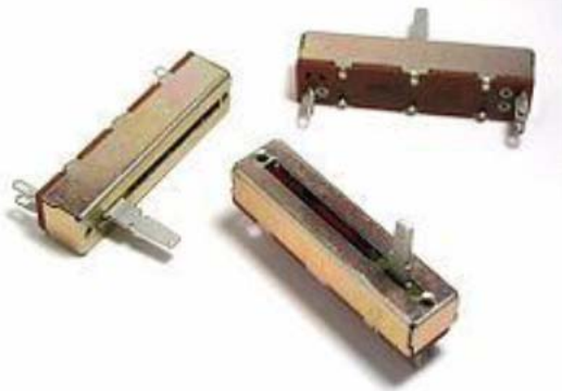
Linear potentiometers ("faders")
